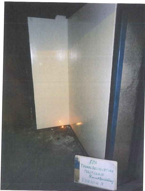
Bild 6: Prüfkörper „Tunnelbeschichtungssystem POLIFUKRIE“ (Beschichtungsdicke 400 \mu\text{m} ) vor dem Versuch 2 – Nahaufnahme der Außenkante
