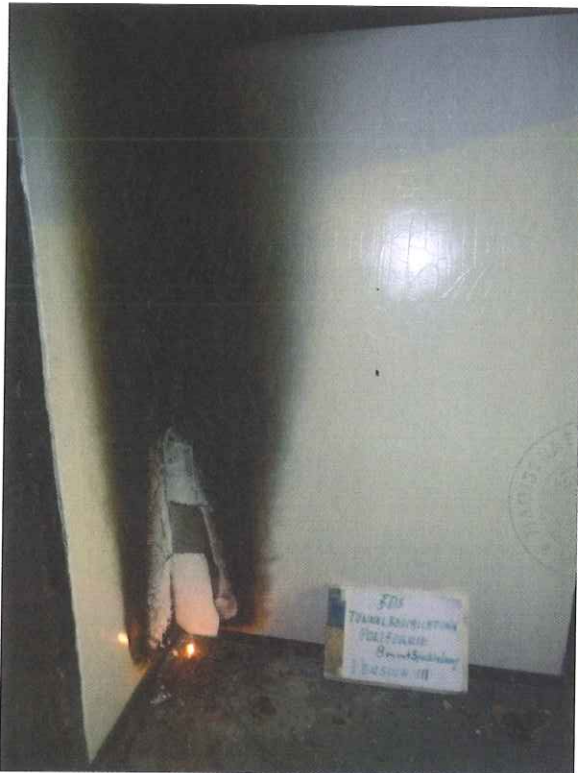
Bild 11: Prüfkörper „Tunnelbeschichtungssystem POLIFUKRIE“ (Beschichtungsdicke 400 µm) nach dem Versuch 3 – Gesamtansicht
