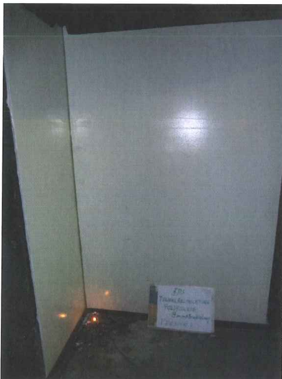
Bild 1: Prüfkörper „Tunnelbeschichtungssystem POLIFUKRIE“ (Beschichtungsdicke 400 µm) vor dem Versuch 1 – Gesamtansicht
