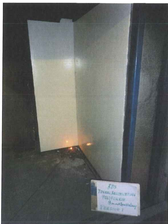
Bild 2: Prüfkörper „Tunnelbeschichtungssystem POLIFUKRIE“ (Beschichtungsdicke 400 µm) vor dem Versuch 1 – Nahaufnahme der Außenkante
