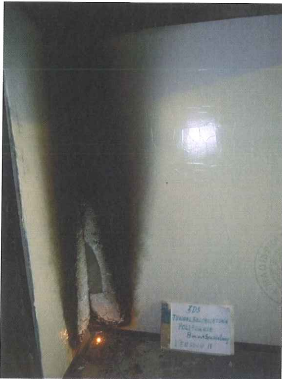
Bild 7: Prüfkörper „Tunnelbeschichtungssystem POLIFUKRIE“ (Beschichtungsdicke 400 µm) nach dem Versuch 2 – Gesamtansicht
