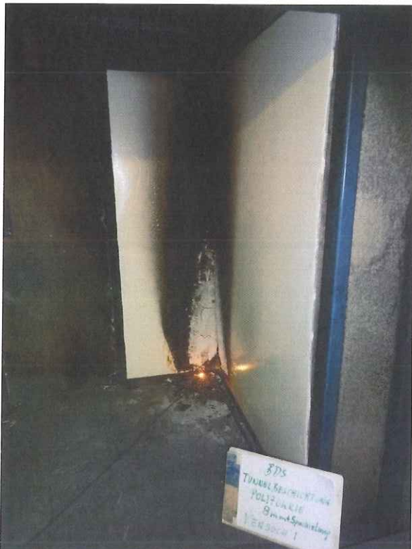
Bild 4: Prüfkörper „Tunnelbeschichtungssystem POLIFUKRIE“ (Beschichtungsdicke 400 µm) nach dem Versuch 1 – Nahaufnahme der Außenkante
