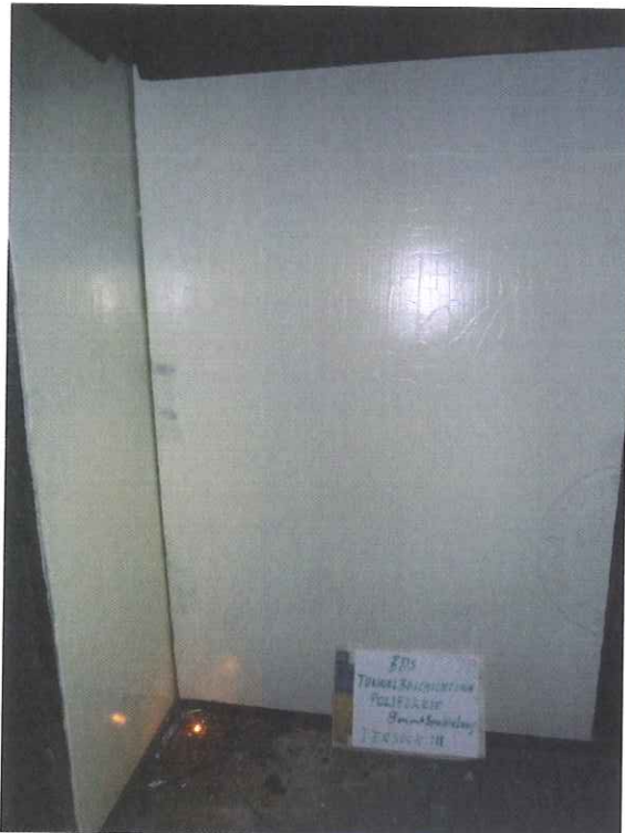
Bild 9: Prüfkörper „Tunnelbeschichtungssystem POLIFUKRIE“ (Beschichtungsdicke 400 µm) vor dem Versuch 3 – Gesamtansicht
